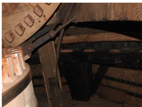
Foto 99 & 100. Detail van het sabelijzer, koebouten en de ophanging van de wipstok.
