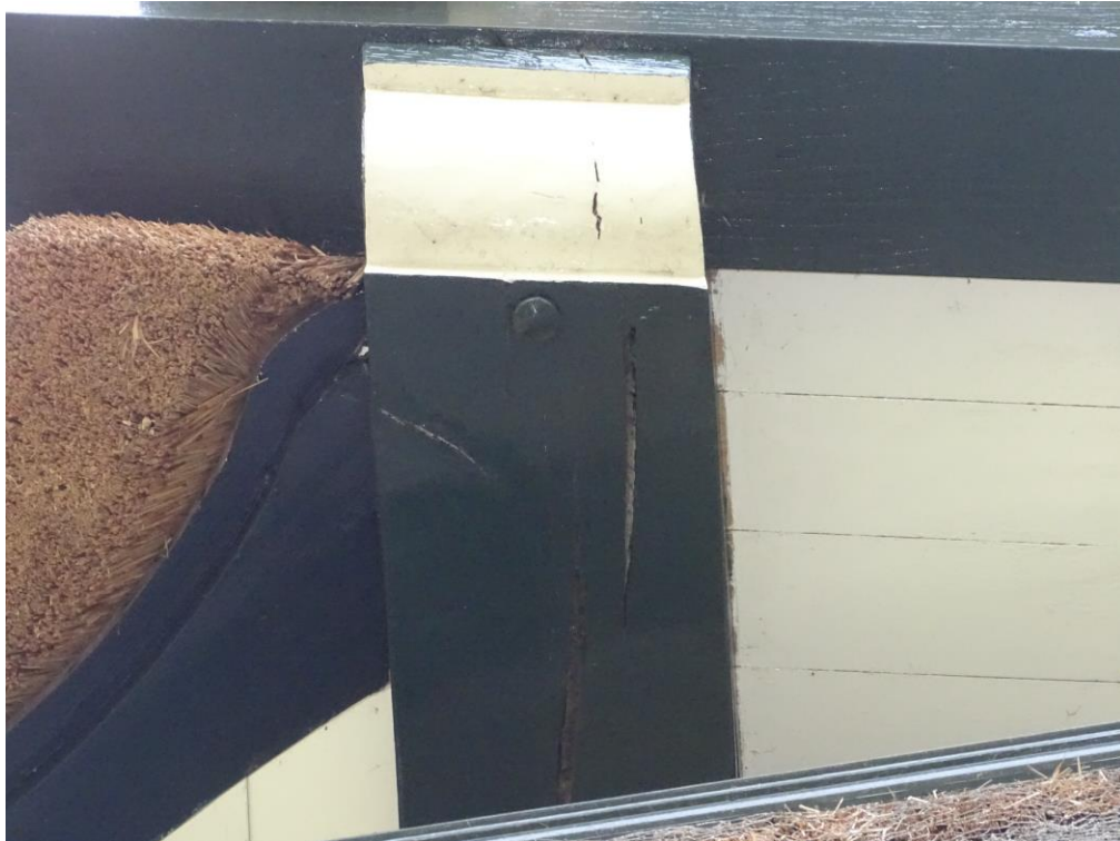
Foto 37. Detail van een voeghoutkop van het achterkeuvelens.
