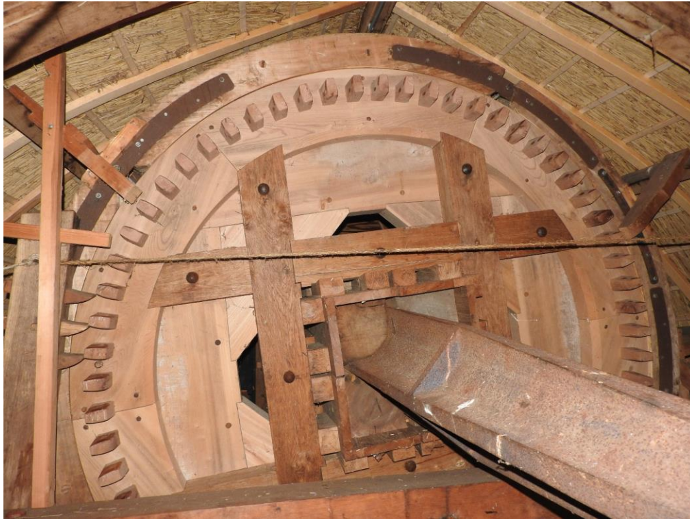
Foto 95. Overzicht van het bovenwiel.
